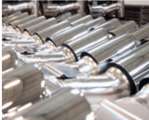
Transparente Nanoseal-Beschichtung auf hochglanzpolierten Edelstahl-Endrohrblenden
