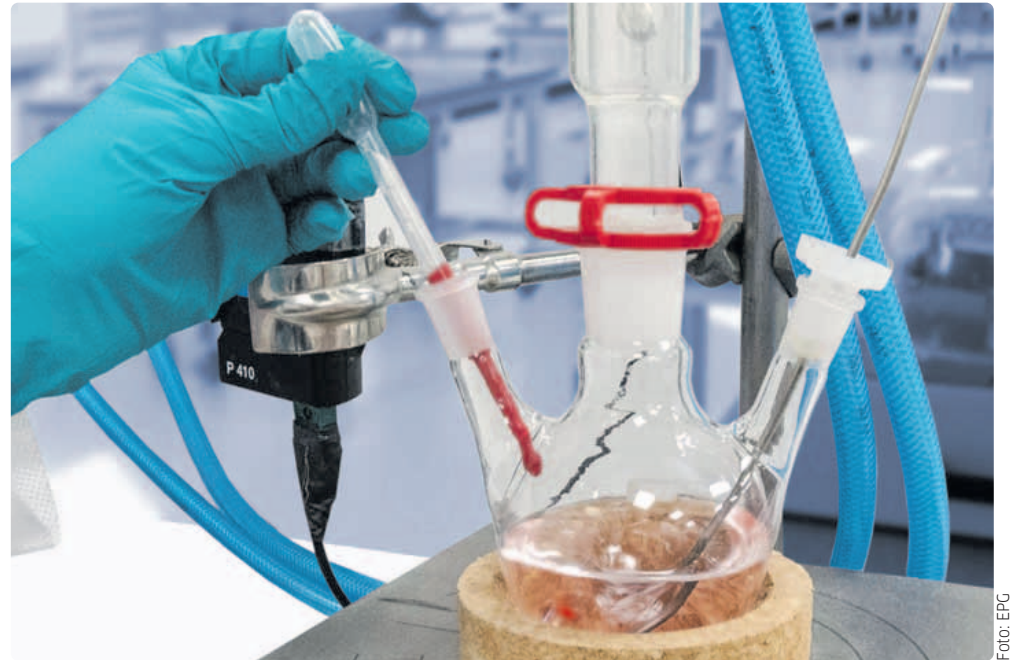
Zugabe einer Pigmentpaste zum Sol-Gel-System
